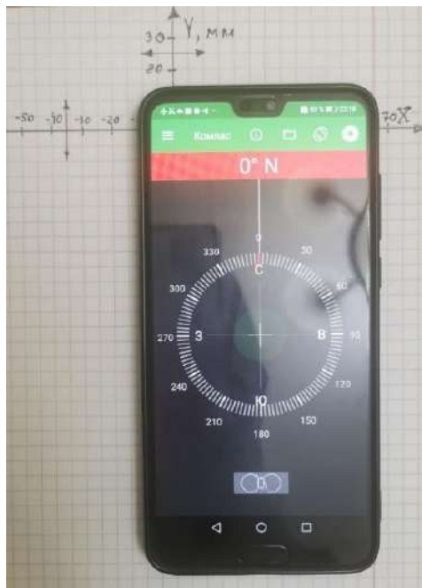
Рис. 3. Орієнтація смартфона та координатної сітки за допомогою компаса
