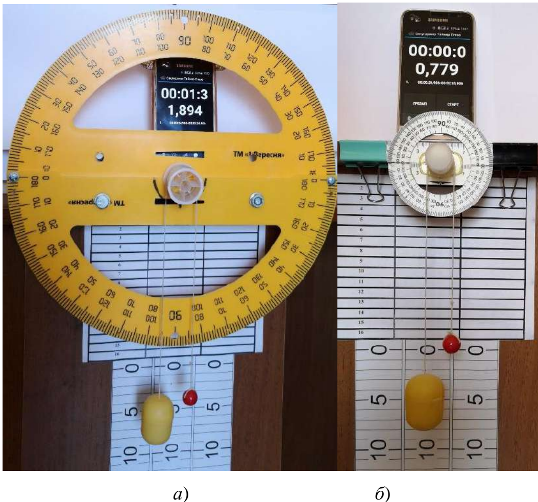
Рис. 2. Фото: а) демонстраційний стенд, б) дослідницька установка
