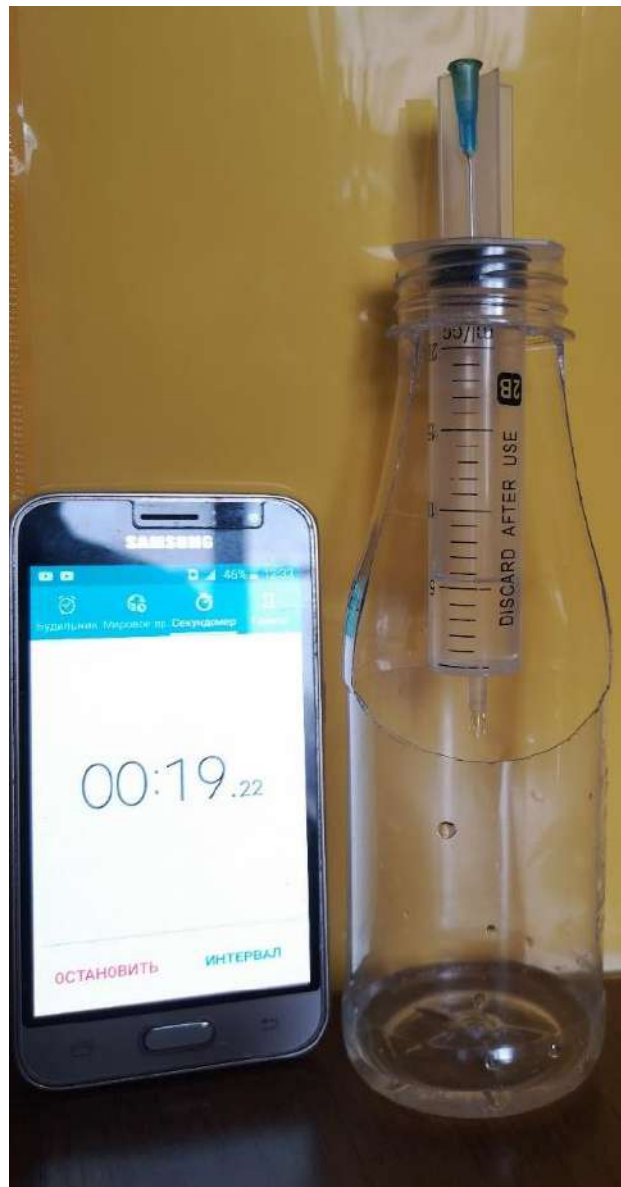
Рис. 1. Установка для дослідження: 1 поділка = 3,35 мм, діаметр внутрішньої трубки голки шприця (калібр 23G) \varnothing 0,337 мм, довжина l = 35 мм
