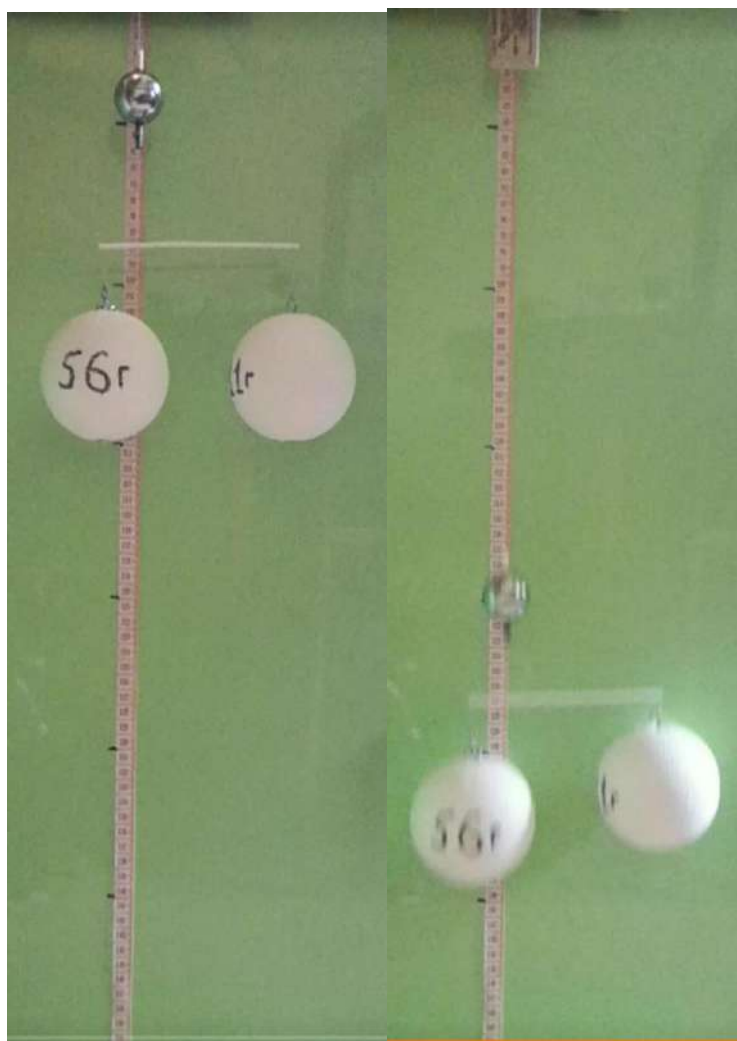
Рис. 9. Фото досліду: ліворуч – стартова позиція, праворуч – сталеву кульку подолали шлях 320 мм, пінопластова кулька (56 г) – 300 мм, пінопластова кулька (11 г) – 280 мм
