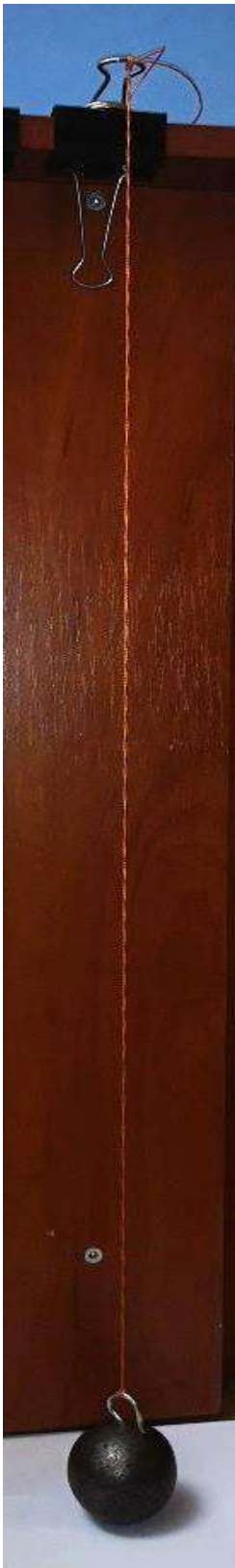
Рис. 1. Вигляд кріплення маятника з залізною кулькою
