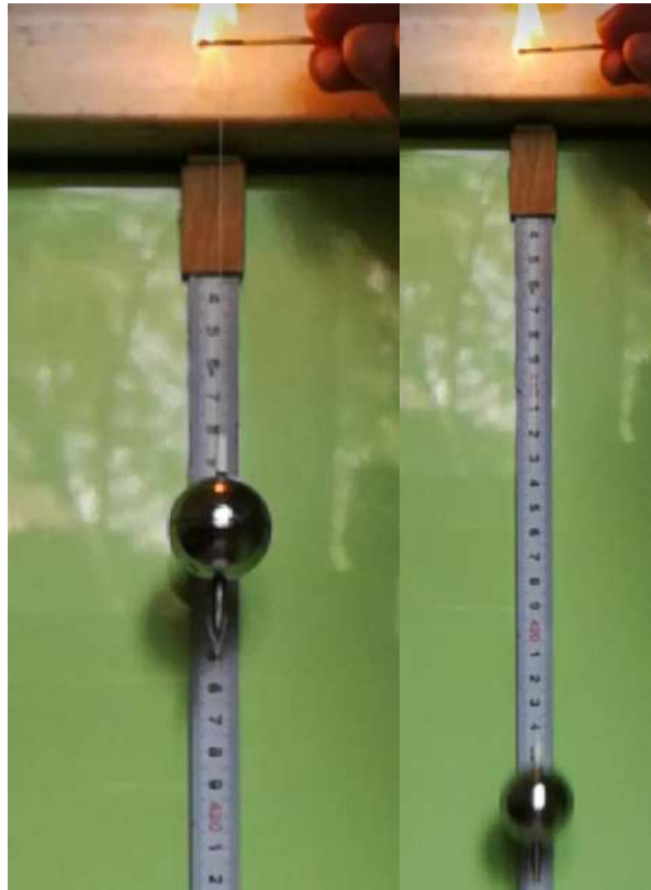
Рис. 1. Кадри уповільненого відео вільно падаючої металевої кулі, знятого за допомогою мобільного телефону
