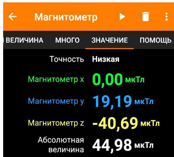
Рис. 4. Phyrphox показує X, Y, Z - компоненти та величину індукції поля B
