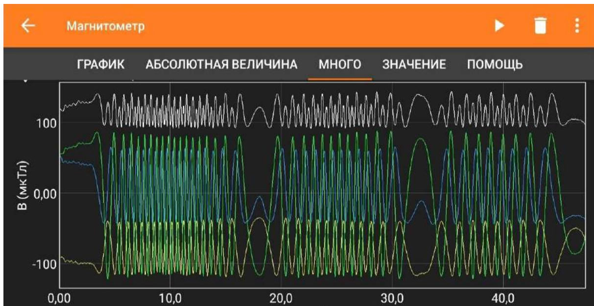
Рис. 7. Осцилограми зміни індукції B_x , B_y , B_z магнітного поля під час обертання залізної кули
