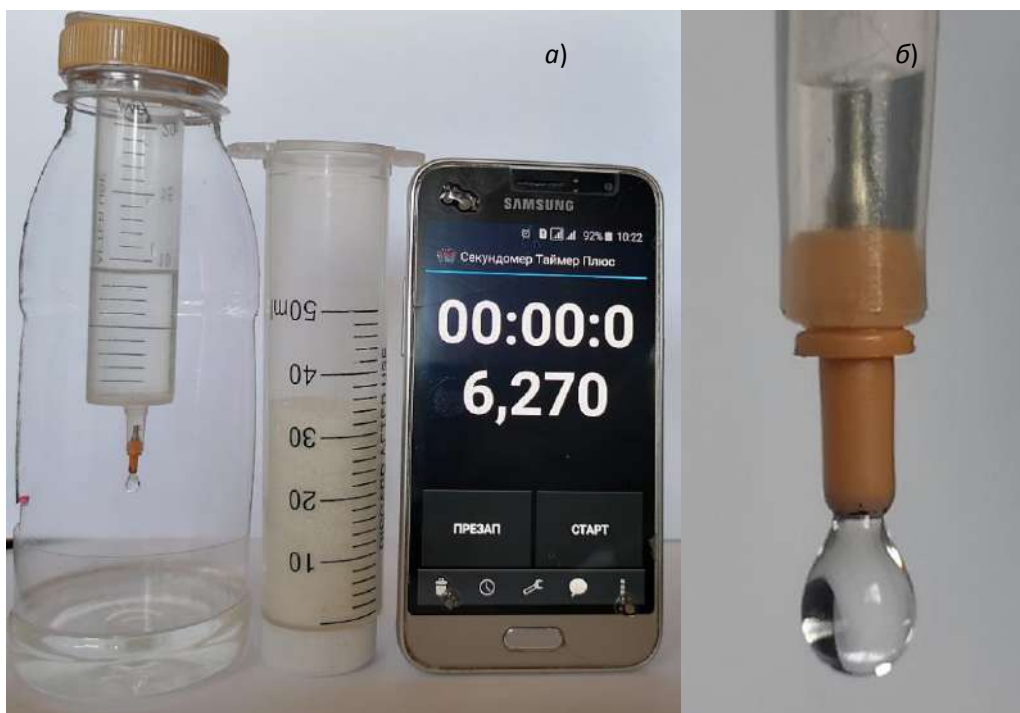
Рис. 2. Дослідницька установка для дистанційного проведення лабораторної роботи
