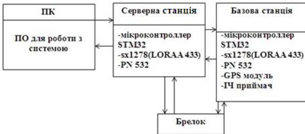
Рис.3.1. Схема пристрою з електронними складовими
