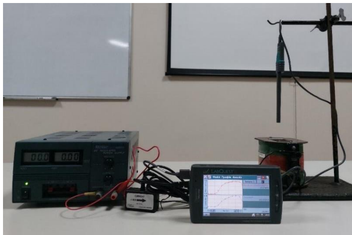
Рис.2.25. Демонстрація створення магнітного поля навколо провідника зі струмом
