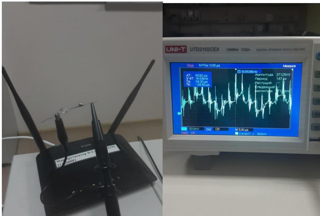
Рис.2.5. Детектування електромагнітного поля поблизу Wi-Fi-роутера
