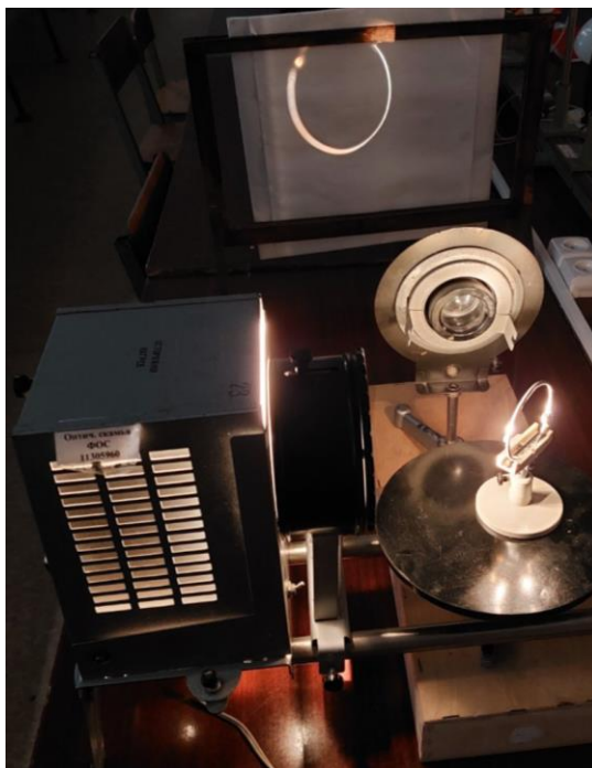
Рис. 2.27. Установка для демонстрації інтерференції світла на тонких плівках
