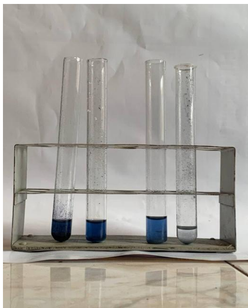
Рис. 2.1 Спряжена реакція нітрат-йонів з йодид-йонами у слабко кислому середовищі у присутності подрібнених металів
