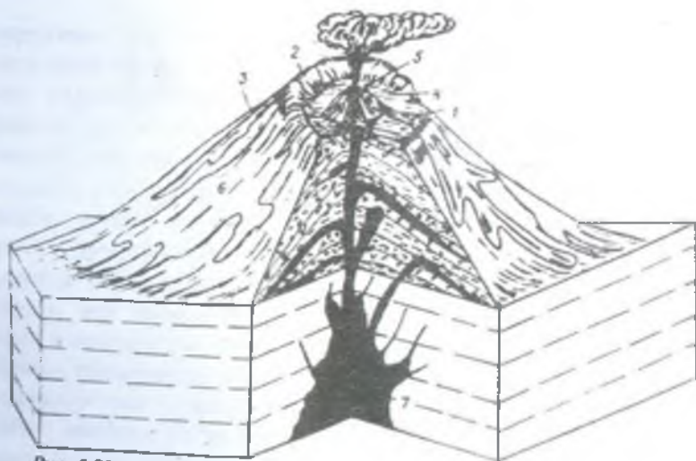
Рис. 5.73. Схема будови вулкану. 1 – кальдера; 2 – сома; 3 – конус; 4 – кратер; 5 – жерло; 6 – лавовий потік; 7 – вулканічний осередок
