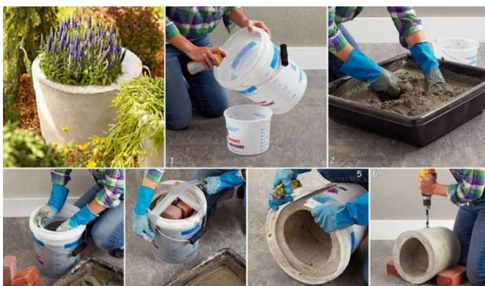
Рис.2.3. Варіант виготовлення вазону з бетону власноруч
