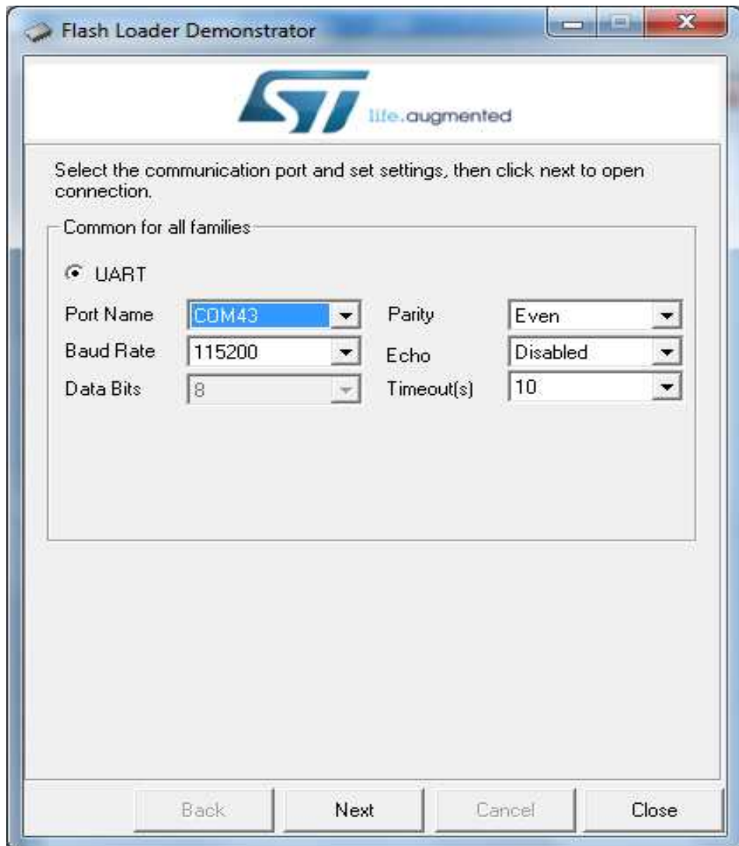
Рис.3.8. Інтерфейс програми STM32 Flash Loader Demonstrator
